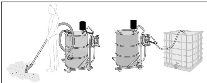
Le PumpOut aspire le liquide du fond et le refoule plus tard dans une cuve de 1000 litres.
