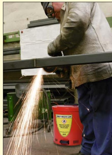
Le couvercle à fermeture automatique évite l'inflammation du contenu par exemple causée par des étincelles.
