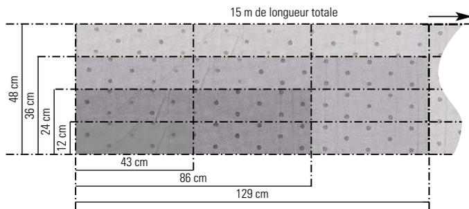
Grâce au multiple prédécoupage dans le sens de la longueur et de la largeur, il est facile de découper le format adapté à chaque situation.
