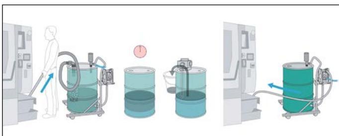
Utilisation combinée : PumpOut (voir ci-dessus) aspire l'eau de refroidissement hors de la machine et sépare les particules du liquide. Un séparateur d'huile sur l'ouverture 2" du récipient écope l'huile de la surface. Ensuite, le liquide purifié est refoulé dans la machine.
